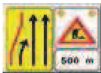
Esempio di presegnale di cantiere mobile
